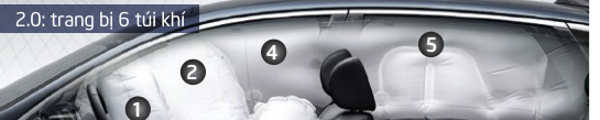
1 Túi khí người lái 2 Túi khí bên phụ 3 Túi khí đầu gối 4 2 túi khí hông 5 2 túi khí rèm
